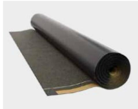
ist konzipiert für einlagigen Aufbau unter einer horizontalen Betonplatte. Das Produkt besteht aus einem leistungsstarken SBS modifizierten Bitumen auf einem ultra hochfesten Kompositrträger. Die Unterseite ist mit einer Flammfolie versehen. Die Oberseite ist mit Spezialsand abgestreut. Die Überlappung ist mit Duo – Rand Technologie ausgestattet.
